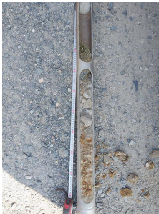
Vlevo: jádro sondy S-1; vpravo jádro sondy S-2
